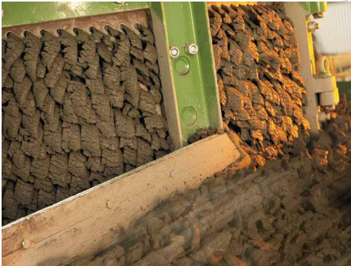
L'argilla è prelevata dai silos di stoccaggio mediante un escavatore a tazze su rotaia e dosata mediante un cassone dosatore.
