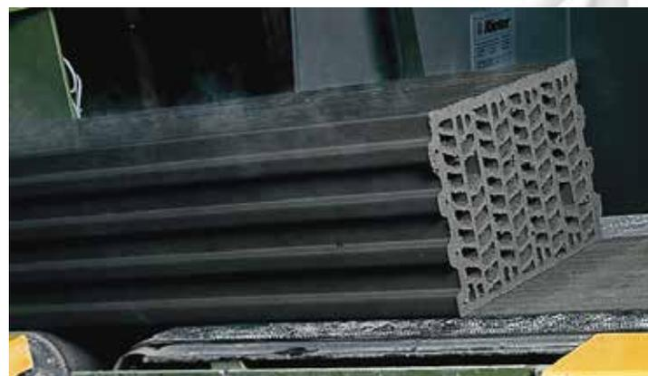
La miscela di argilla situata in tre ampi cassoni dosatori che fungono da buffer, è inviata a due linee di laminazione ed estrusione tramite nastri trasportatori.
